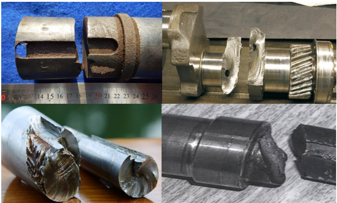
Hình 1.1 Các dạng phá hủy trên trục quay
