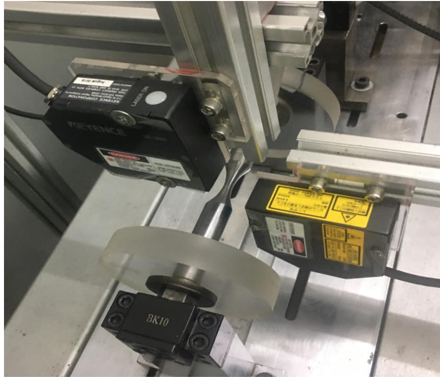
Hình 4.3 Sơ đồ bố trí cảm biến LK–G35 trong hệ thống
