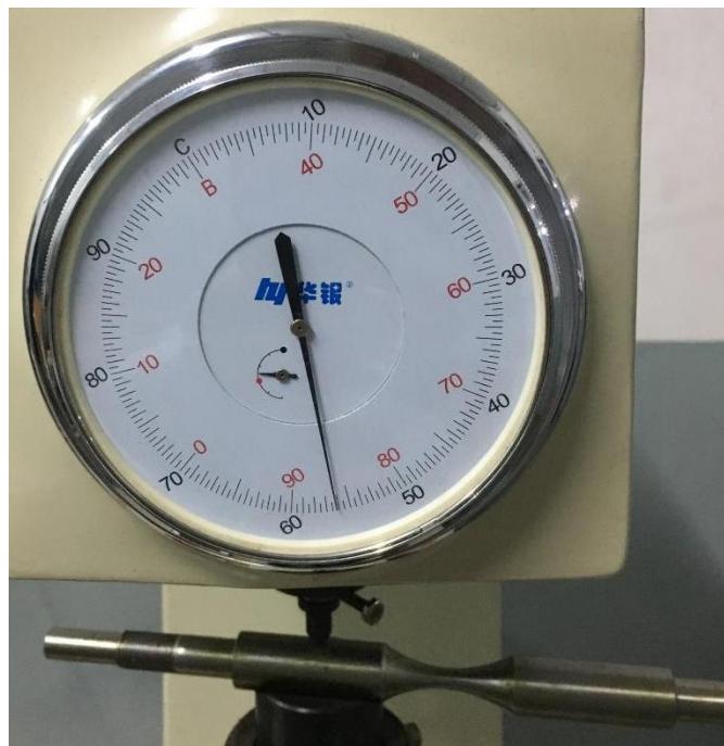
Hình 5.17 Máy đo độ cứng Rockwell HR-150A
