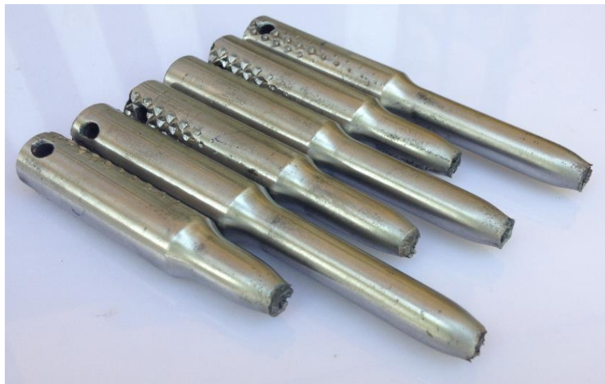
Hình 5.15 Mẫu thử sau khi được kiểm tra độ bền kéo và nén
